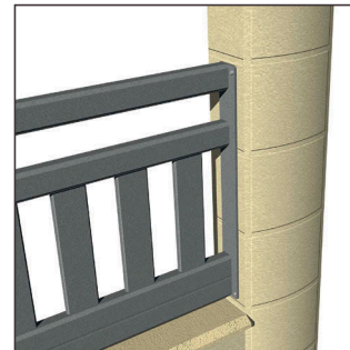
Fixation clôture avec plat
