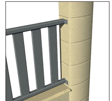
Fixation clôture avec platine
